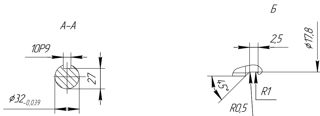
Рисунок В.8 (обязательное) Габаритные, установочные и присоединительные размеры двигателей АИМУ основного исполнения. (с удлиненным валом АИМУ 180)
